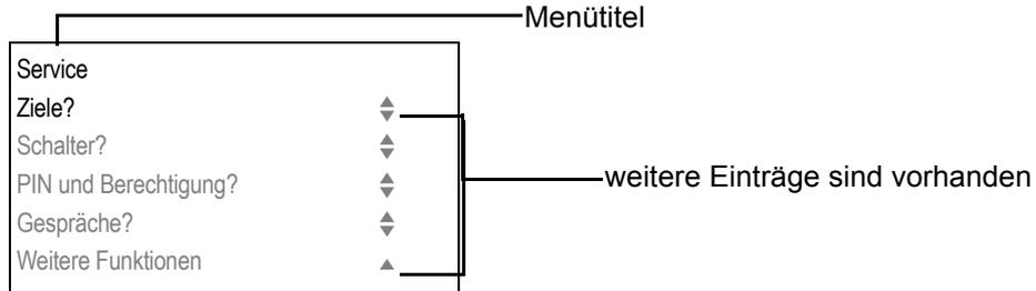
Die Menüstruktur umfasst mehrere Ebenen. Innerhalb dieser Struktur zeigt die erste Zeile das gerade gewählte Menü, die weiteren Zeilen die Optionen dieses Menüs. Der Pfeil neben einem Eintrag bedeutet dass der entsprechende Eintrag weitere Optionen enthält.
