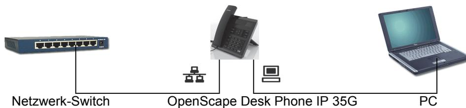
Durch diese Anschlussart sparen Sie jeweils einen Netzwerk-Anschluss des verwendeten Switches und benötigen bei entsprechender Anordnung weniger Netzwerk-Kabel bzw. nutzen kürzere Leitungswege.
